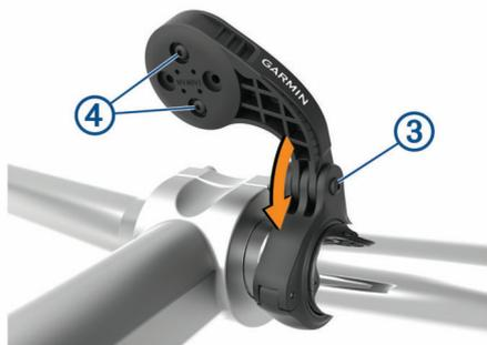
6 Si nécessaire, retirez les deux vis à l'arrière du support ④ à l'aide de la clé Allen de 2 mm. Retirez et faites pivoter le connecteur, puis remettez les vis en place pour modifier l'orientation du support.
