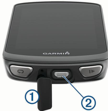
2 Branchez la petite extrémité du câble USB sur le port USB situé sur l'appareil.
