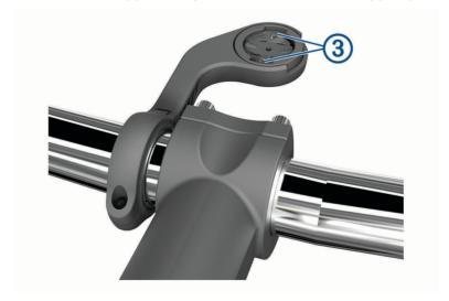
7 Appuyez légèrement sur l'appareil Edge et faites-le pivoter dans le sens des aiguilles d'une montre jusqu'à ce qu'il soit bien en place.
